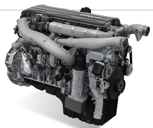
O motor PACCAR MX-11 Euro 6 de 10,8 litros utiliza tecnologia common rail ultramoderna, um turbo com geometria variável e controlos avançados para maximizar a eficiência. Para cumprir os exigentes requisitos de emissões da norma Euro 6, inclui recirculação dos gases de escape combinada com um filtro de fuligem activo e tecnologia SCR.
